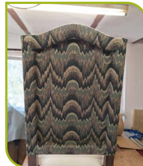
GAINAGE DU DOSSIER EXTÉRIEUR AVEC LES RACCORDS DE MOTIFS AU NIVEAU DU TISSU
